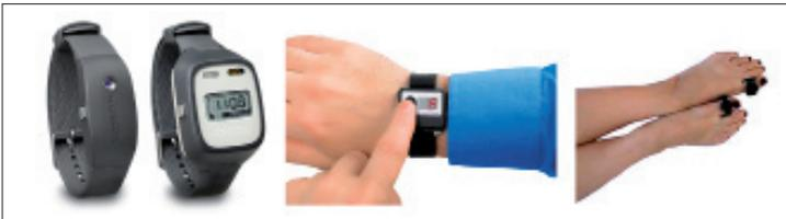
Ein vollständiges Aktimetriesystem besteht aus einem Aktimeter, einer Schnittstelle zur Übertragung der Daten zu einem Computer und Software zum Einstellen der Aufzeichnungsparameter und Auswertung der digitalen Aufzeichnung.
